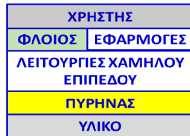
Εικόνα 4.2: Σχηματικό διάγραμμα των συστατικών του λειτουργικού συστήματος και της θέσης του χρήστη
