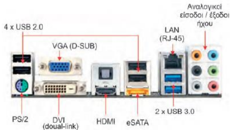
Εικόνα 3.8. Υποδοχές (θύρες) διασύνδεσης εξωτερικών περιφερειακών συσκευών μιας σύγχρονης μητρικής πλακέτας.
