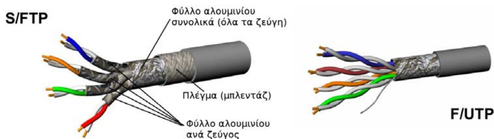
Εικόνα 2.4.1.η: Θωρακισμένα καλώδια συνεστραμμένων ζευγών.
