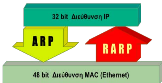
Εικόνα 3.3.στ: Σχέση ARP/RARP και διευθύνσεων
