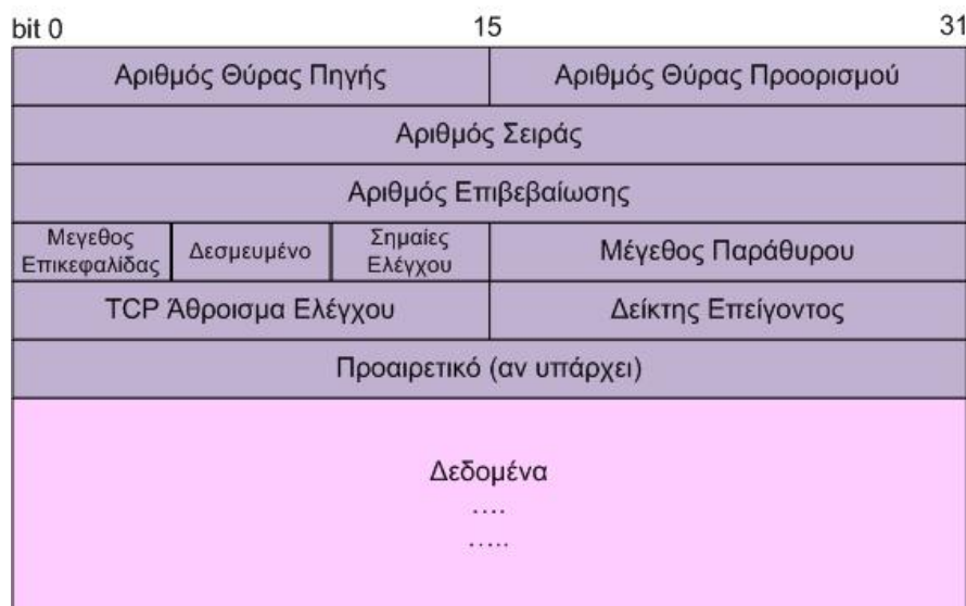
Εικόνα 4.1.1.γ: Πεδία της επικεφαλίδας ενός TCP τμήματος.
