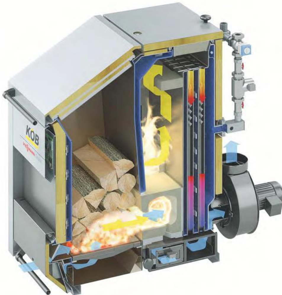
Σχήμα 7.10: Λέβητα καυσοξύλων σε τομή που παρουσιάζει την ροή των καυσαερίων
